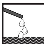
Eviter l'entrée de condensat dans le pressostat, une prise en glace par température négative nuirait à son fonctionnement.
